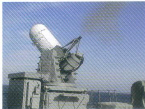
高性能20ミリ機関砲 (20mm Close in Weapon System) 対空目標に対処するため自動で発射する機関砲です。
