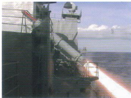
艦対艦ミサイル発射装置 (SSM-1B / Harpoon) 水上目標に対処するため、国産のSSM-1Bを発射する装置です。
